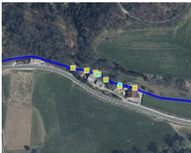
Slika 15: Primer kritičnega odseka vodovodnega sistema s prikazom okvar – Stranske Makole
